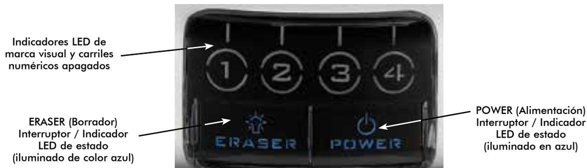
Figura 4. Indicadores del panel delantero del modo listo
