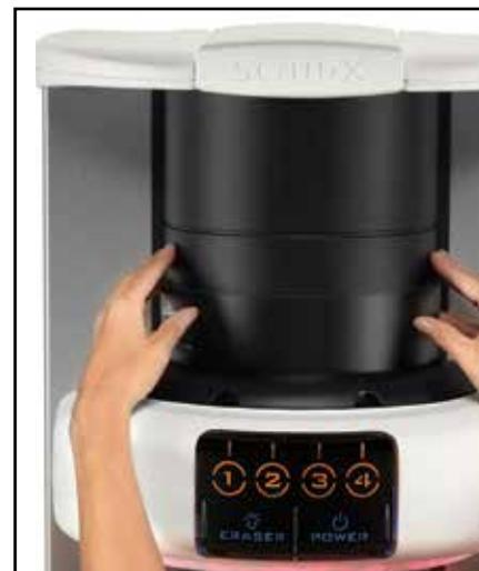
Figura 13. Alimentación de una placa panorámica en el sistema ScanX Classic
