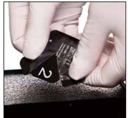
Figura 9. Expulsión de una placa a la caja de transporte de placas
