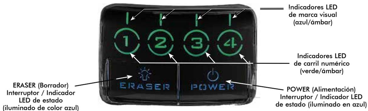
Figura 11. Indicadores del panel delantero del sistema ScanX activado, fijados en el modo listo
